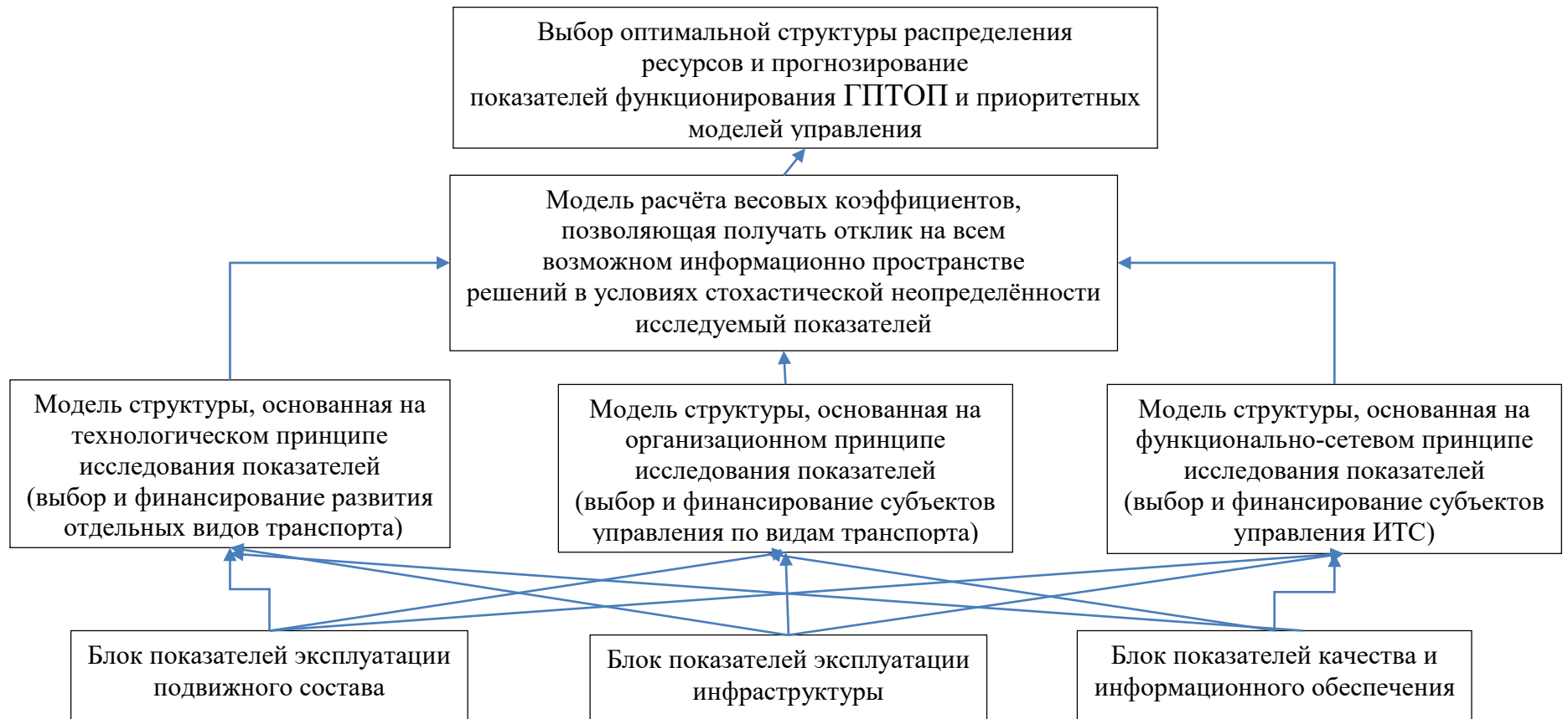
Рисунок 3.17 – Схема структуры системы распределения ресурсов ГПТ
